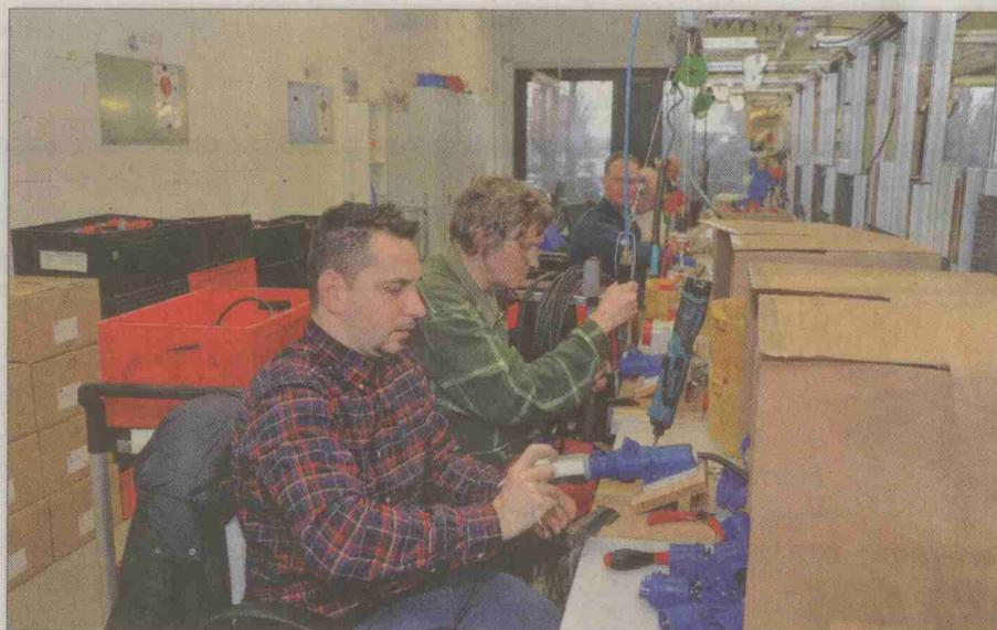
An Druckluftschrauberplätzen werden Anschlussleitungen, die etwa beim Antrieb eines Garagentores zum Einsatz kommen, montiert. Fotos (2): Vera Demuth
